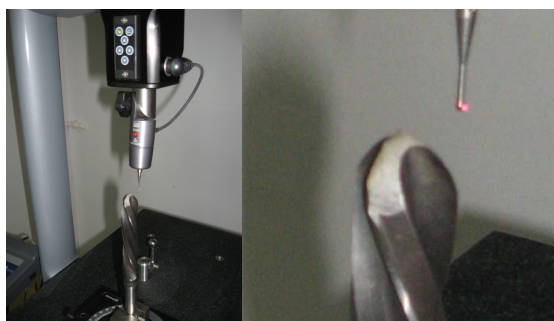
Fig.1. Măsurarea de coordonate pe generatoarea unei suprafețe elicoidale cilindrice de pas constant (măsurată pe mașina Micro Hite 3D)
