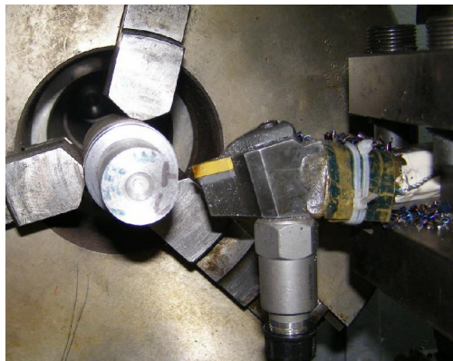
Figura 4. Amplasarea accelerometrului la nivelul sculei așchietoare
