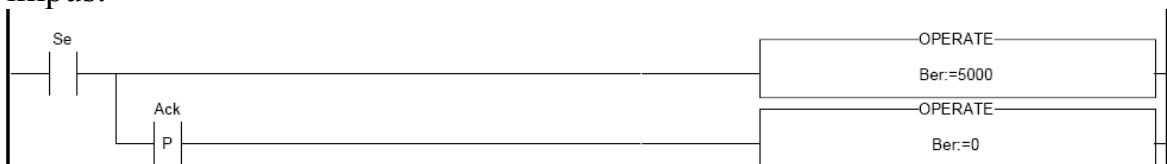
Fig. 5.7. Secțiunea erori. Resetarea cod eroare
