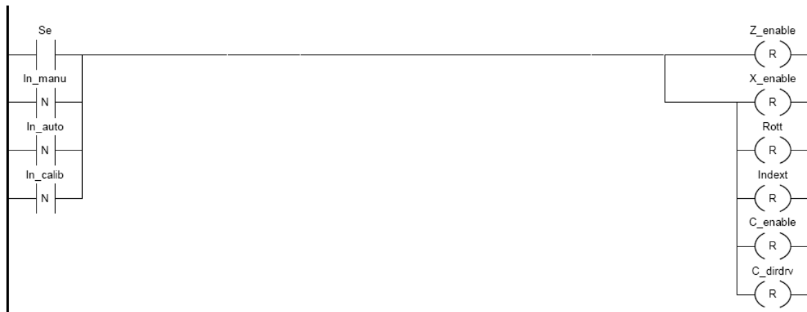
Fig. 5.55. Postprocesare. Interblocajele aplicației
