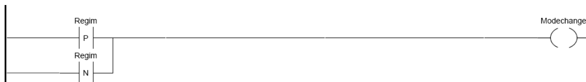
Fig. 5.23. Preprocesare. Detectarea solicitării de schimbare a modului de lucru
