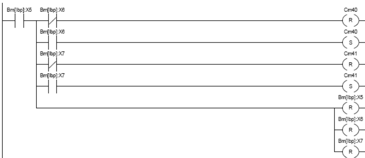
Fig. 5.33. Activare a biților corespunzătorii funcțiilor M40, M41, M42, M43
